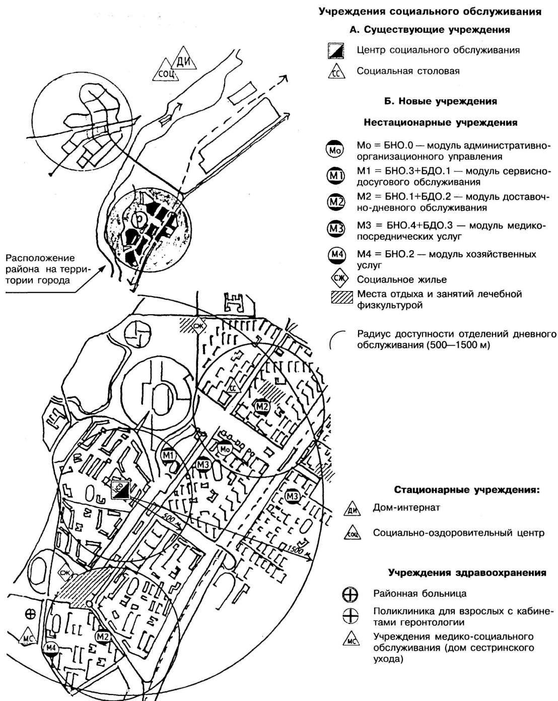
Рисунок 6.2 — Блок-модульный метод размещения учреждений социального обслуживания пожилых людей в сложившемся районе города
